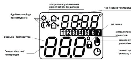
Терmostat призначений для підтримки постійної температури від мінус 20 до 40 °C. Температура контролюється в місці розташування виносного датчика.
